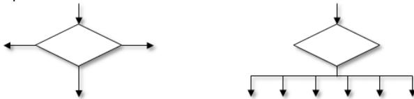
6. Вместо одного символа с соответствующим текстом могут быть использованы несколько символов с перекрытием изображения, каждый из которых может содержать дополнительный текст (например, запись или посылка нескольким получателям, подготовка нескольких копий документа и т. д.).
